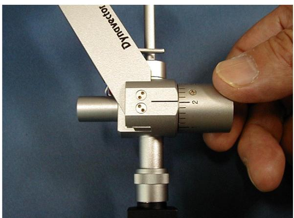
Vous constaterez en même temps que le montage du talon du contrepooids est flexible, c'est délibéré et une caractéristique conçue pour réduire les résonances dans le bras.
